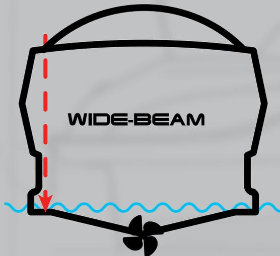
In Ruhelage wirken senkrechte Kräfte (roter Kraftpfeil) INNERHALB der Wasserauflagefläche hierdurch bleibt eine Seitenneigung (Krängung) des Bootes aus.
