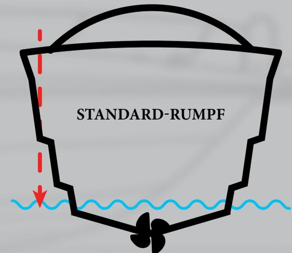
In Ruhelage wirken senkrechte Kräfte (roter Kraftpfeil) AUSSERHALB der Wasserauflagefläche und zwingt das Boot so in Schräglage.
