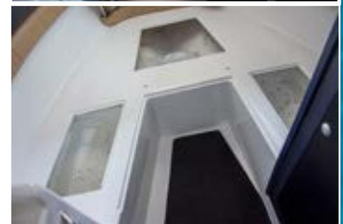
Der **Pantryblock** aus einem pflegeleichten und abgerundeten GFK-Formteil beinhaltet ein großes Spülbecken mit vorinstalliertem Wasserablauf sowie seitliche Lüftungsfenster und eine Dachluke.
