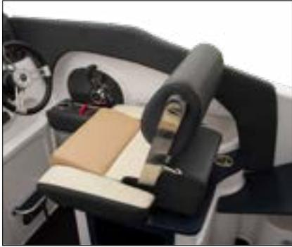
**Pantry** - der Fahrerstand lässt sich zur Pantry inkl. Waschbecken umfunktionieren. Der Tisch kann hier als Theke/Bar eingesetzt werden und je nach Bedürfnissen zum Bug oder Heck ausgerichtet werden.
